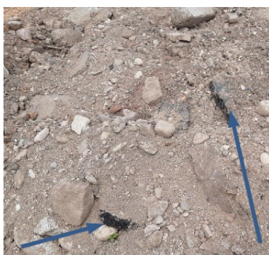
Déchets bitumineux dans le remblai
